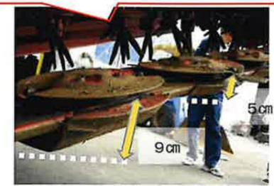
図3 モコゲイシオ:通常の部品(右)とオープンソリのソリ(左)を装着したものの高さを比較
