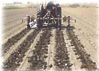
写真2 深耕爪カルチによる盛土
