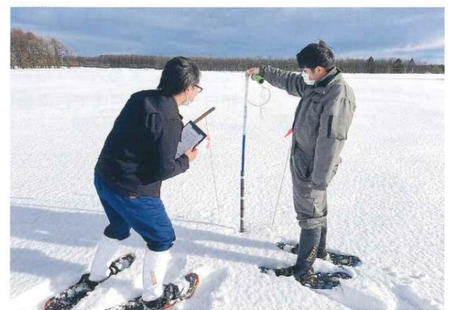
外管の内側にある観測管を引き出して計測を実施
